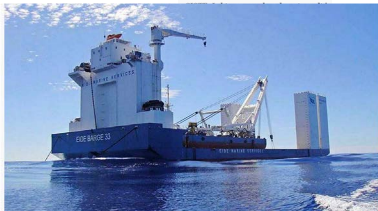
Leierskipet Eide Barge 33 som er i drift er svært grunn, bare omlag 1,5 meter under havflaten. Den er utstyrt med tre høye overbyggs, som gjør at vinden får godt tak. FOTO: Eide
