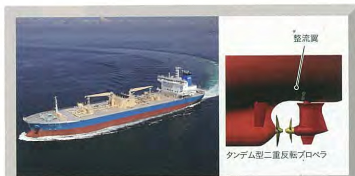
図2 セメント船のスーパーエコシップ 興山丸(左)とその推進システム(右)
