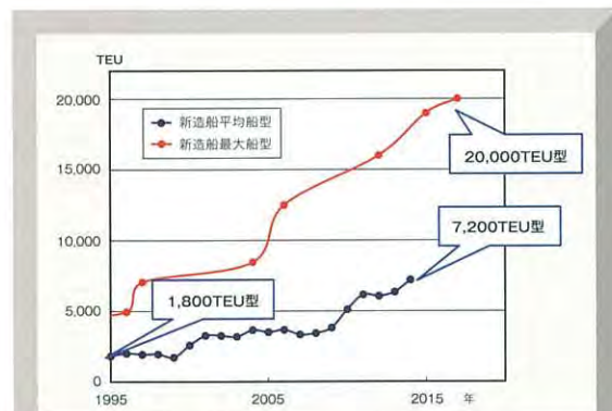
図11 コンテナ船の船型の変遷 [「海事レポート」(国土交通省)を基に作成]
