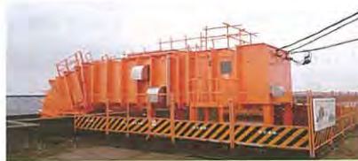
図2 酒田港での波力発電実証試験(2015年1月～9月)
